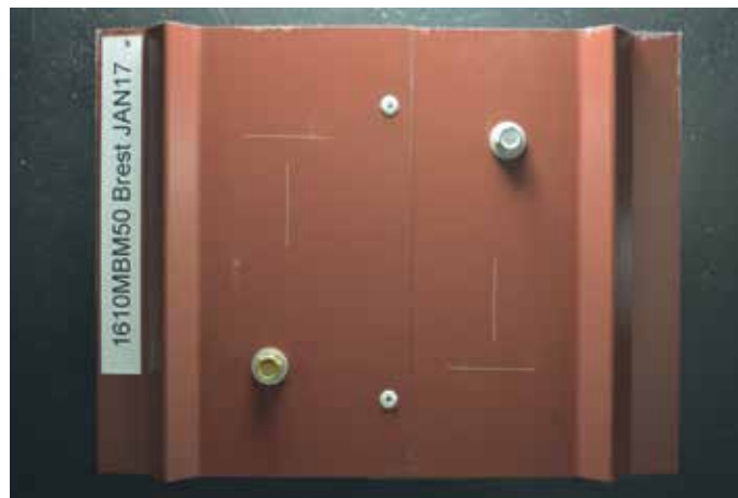
Ein standardisiertes Muster von Colorcoat SDP 50 für Tests im Freien. Nach 4 Jahren wurden die Proben bewertet. Die RC5+ Kriterien nach EN 10169 wurden erfüllt.
