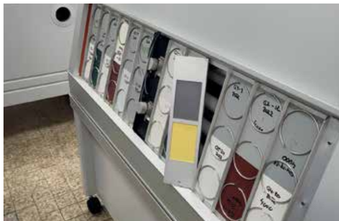
Laboraüstung zur Prüfung der UV-Beständigkeit
