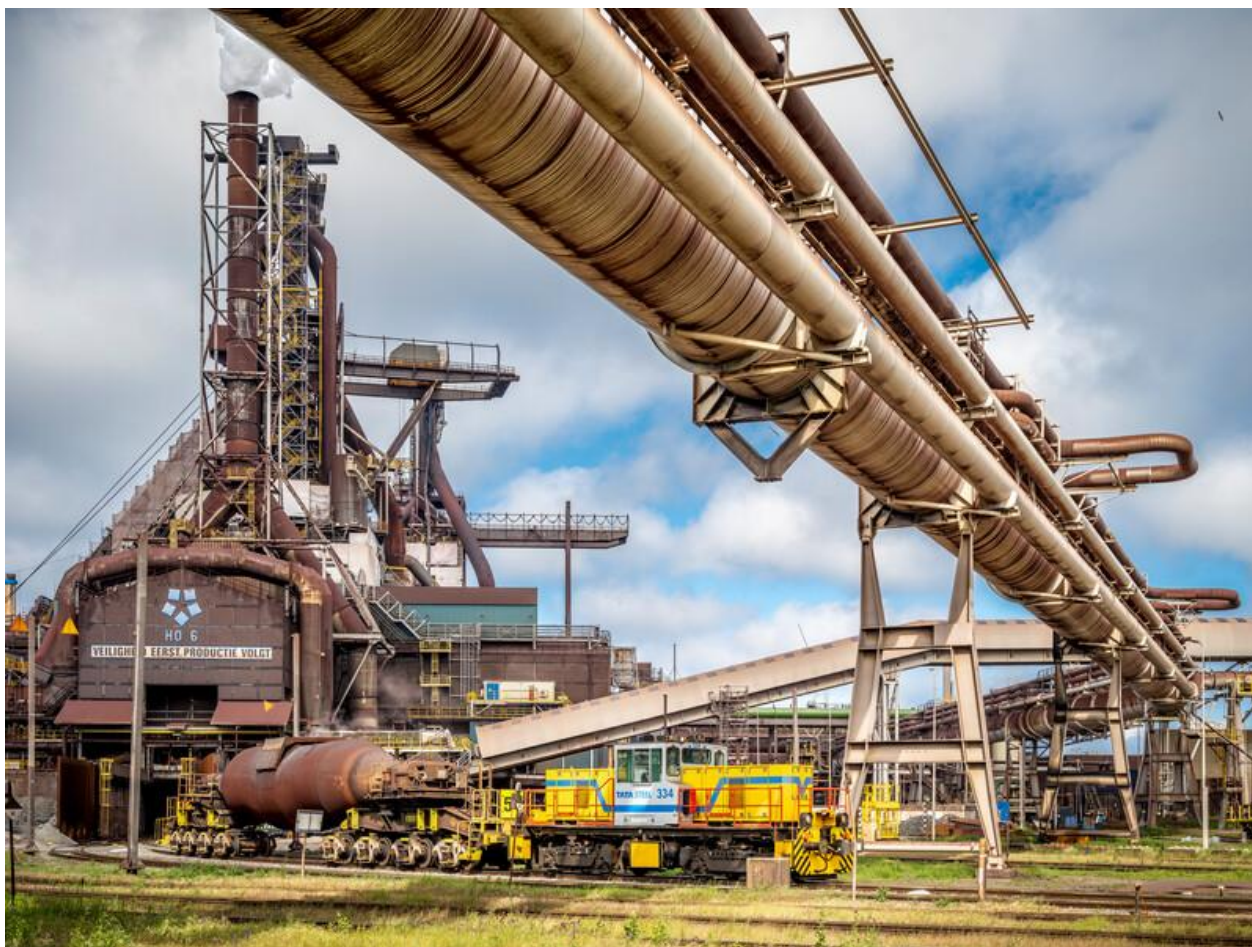
Figuur 3.7: Transport van ruwijzer uit de Hoogovens over het spoor in een torpedo.
